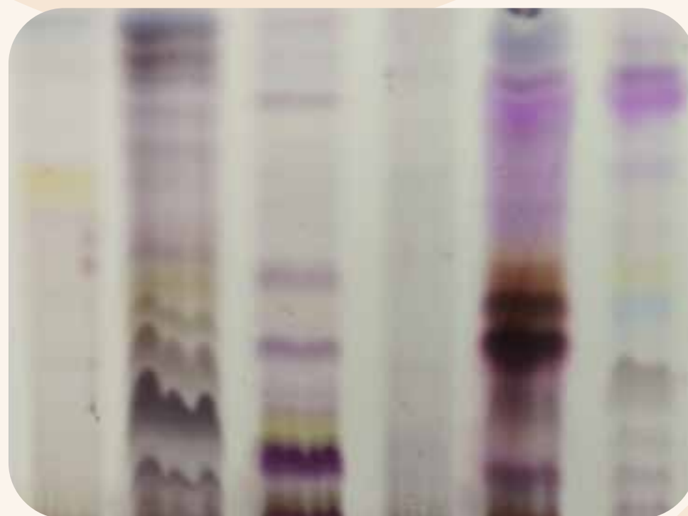
Descifrando el "perfil químico" de las plantas. Mediante una técnica llamada cromatografía en capa delgada, logramos separar los múltiples componentes de un extracto vegetal. En la imagen se observa cómo cada banda representa una molécula distinta que ha migrado gracias al uso de solventes específicos. Este proceso es fundamental para identificar y aislar aquellos compuestos puros que luego evaluaremos como posibles agentes antivirales.
