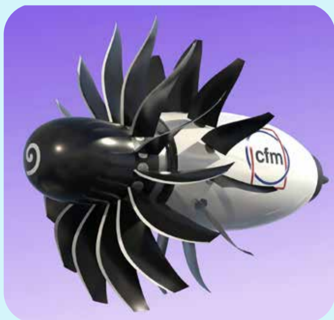
Arquitectura de rotor abierto, sin capotas CFM-GE. (Fuente: GE Aerospace website – 19/Nov/24)
