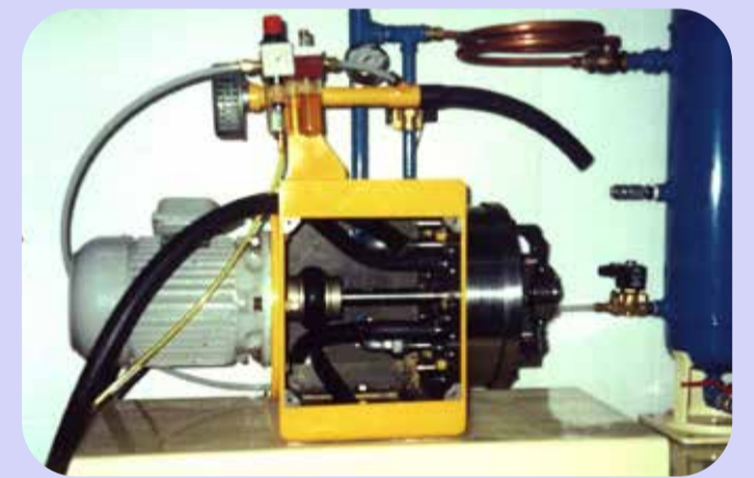
Montaje final: compresor en banco
