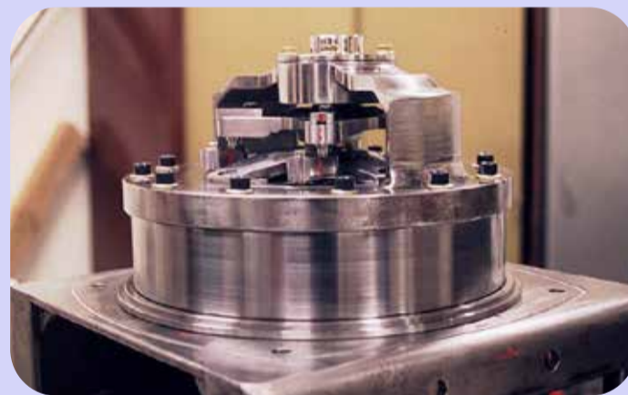
Montaje del sistema: prototipo compresor
