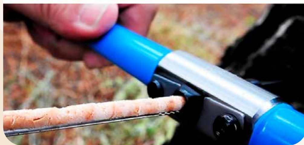
La barrena de Pressler permite extraer cilindros de un centímetro de diámetro del interior de los troncos, para luego ser estudiados en el laboratorio.
