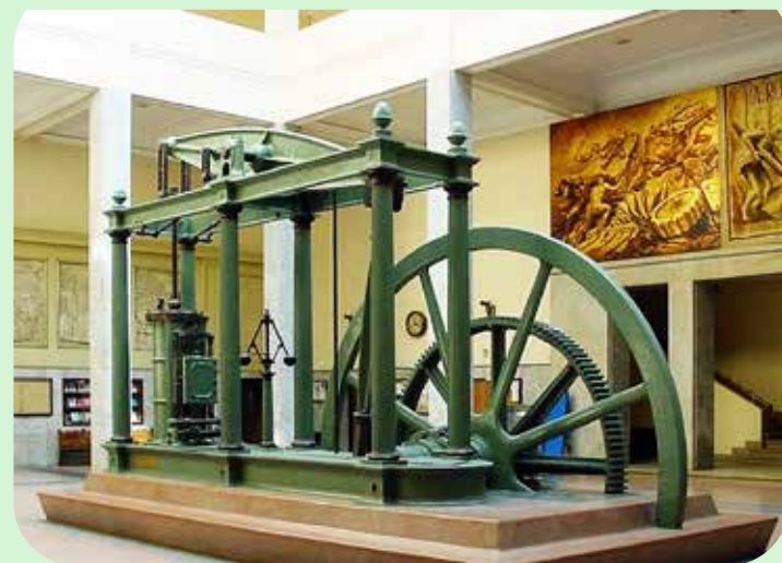
En 1769 el escocés James Watt patentó la primera Máquina a vapor práctica y eficiente, que impulsó la Revolución Industrial.
