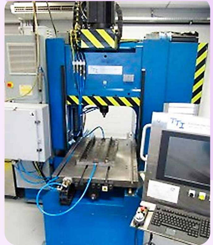
Equipo para soldadura FSW.
