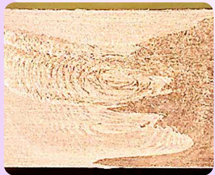
Macroestructura de corte transversal de una soldadura FSW de aleaciones de aluminio disímiles. (Fuente: TRA-C Industrie)
