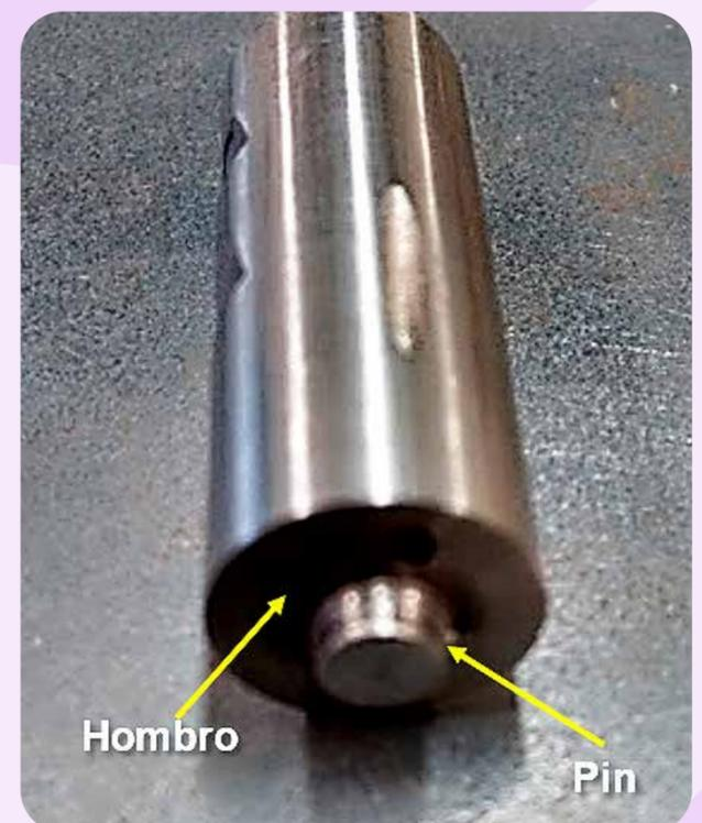
Imagen que indica pin y hombro de la herramienta usada en la soldadura FSW.
