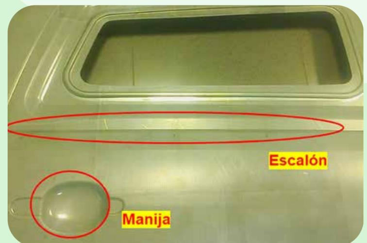
Puerta de camioneta conformada a partir de chapa de acero de 0,7 mm de espesor. En ella están indicadas dos zonas proclives a la aparición de fisuras. (Fuente: El autor)
