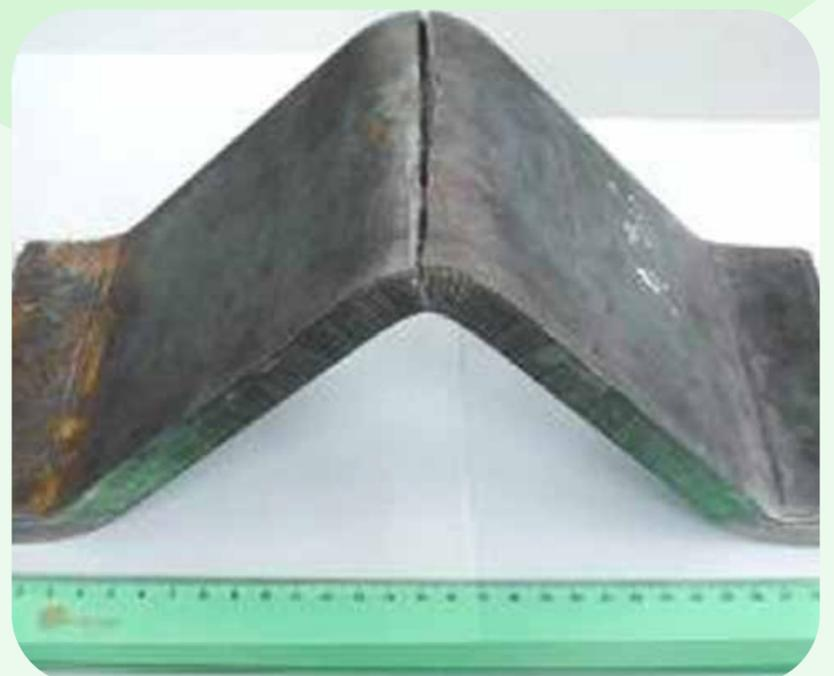
Chapa de acero de 12,7 mm de espesor, para uso en la industria agrícola que presenta fisura en plegado (cara exterior).
