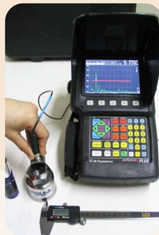
Examinando una tuerca con ultrasonido. (Fuente: el autor)
