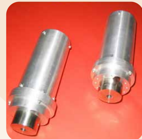
Trasductor para atomización masiva de fluidos y transductores utilizados en Minería (Fuente: El autor)
