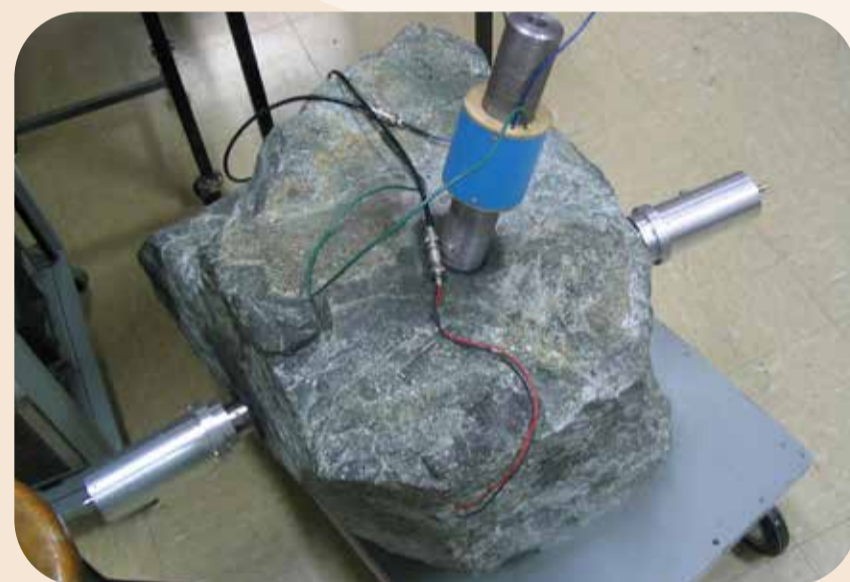
Trasductor de potencia utilizado en Minería para investigar rocas. (Fuente: El autor)
