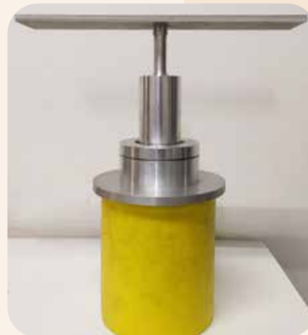
Trasductor para atomización masiva de fluidos y transductores utilizados en Minería (Fuente: El autor)
