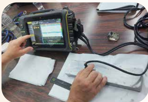
Inspección con el método ultrasonido.
